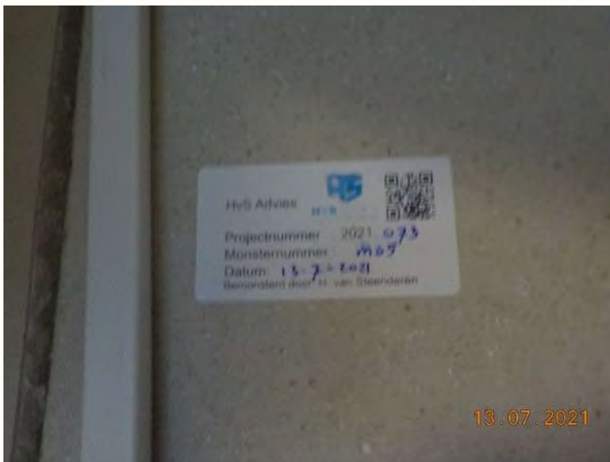
Foto 5: Bron B02, Asbestvrije wandbeplating
