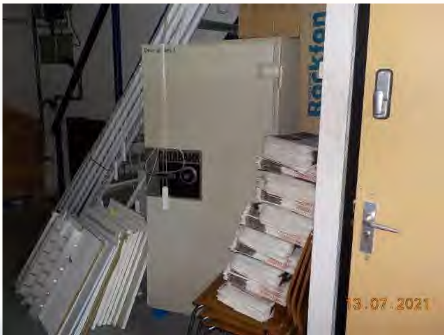
Foto 2: Bron B01, kluis met mogelijk asbesthoudende isolatie
